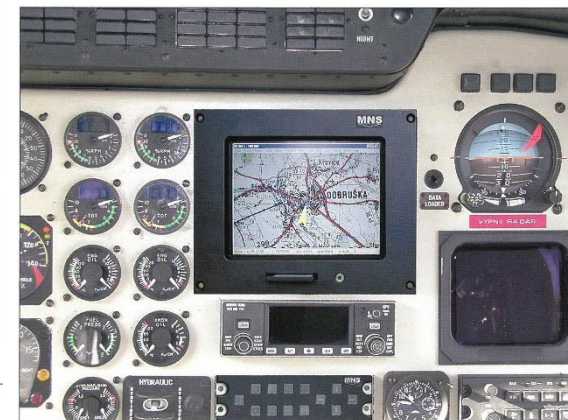
Technické řešení zástavby Modulárního navigačního systému do palubní desky vrtulníku Sokol.
